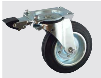
Richtungsfeststeller (RFST) Fixiert die Lenkrolle in Laufrichtung geradeaus, ermöglicht Geradeausfahrt ohne seitliches Ausbrechen
