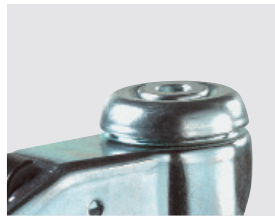
Rückenloch Zum Durchstecken von Schrauben zur Befestigung an Metall- oder Holzkonstruktionen (Ø 10/12 mm)
